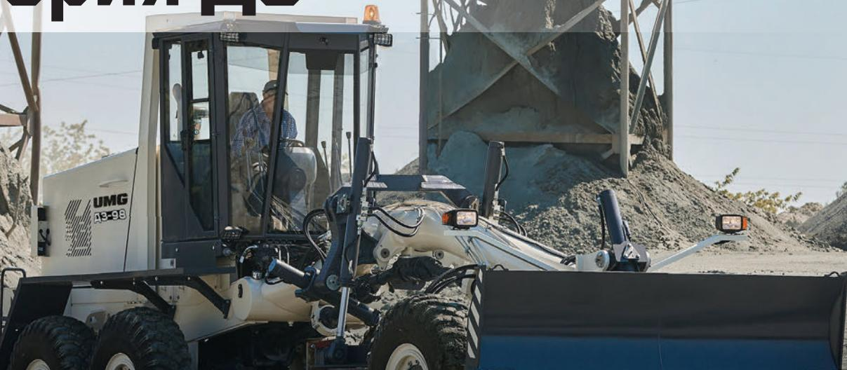
Автогрейдер ДЗ-98В – тяжелый полноприводный грейдер для выполнения энергоемких землеройно-профилировочных работ в различных грунтовых условиях. Он с легкостью справится как с капитальным ремонтом грунтовых и гравийных дорог, так и с устройством выемки под основание дороги в грунтовом полотне. Ему под силу перемещение грунта в насыпь, рыхление мерзлых и тяжелых грунтов, разрушение дорожных покрытий, а также перемещение инертных материалов со стабилизирующими добавками при смешивании их на дороге.
